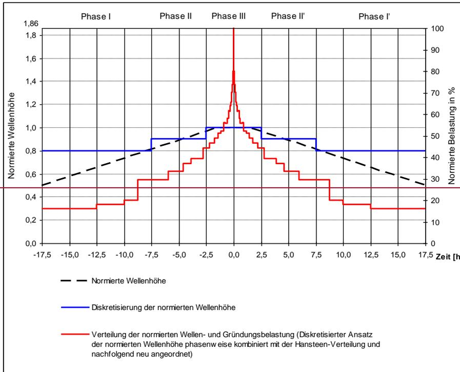
**Abbildung 3-1.3:** Wellenverteilung und durch die Wellenbelastung induzierte normierte Gründungslasten für einen 100-jährigen Bemessungsturm mit fünfständiger Starkwindphase bei Einteilung in 5 Sturmphasen
