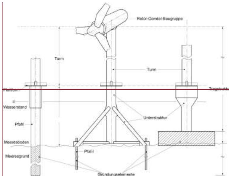
**Abbildung 1-1:** Darstellung der Komponenten des mechanischen Gesamtsystems „Offshore-WEA“ sowie „Offshore-Station“ kann der DIN 18088-1 entnommen werden.
