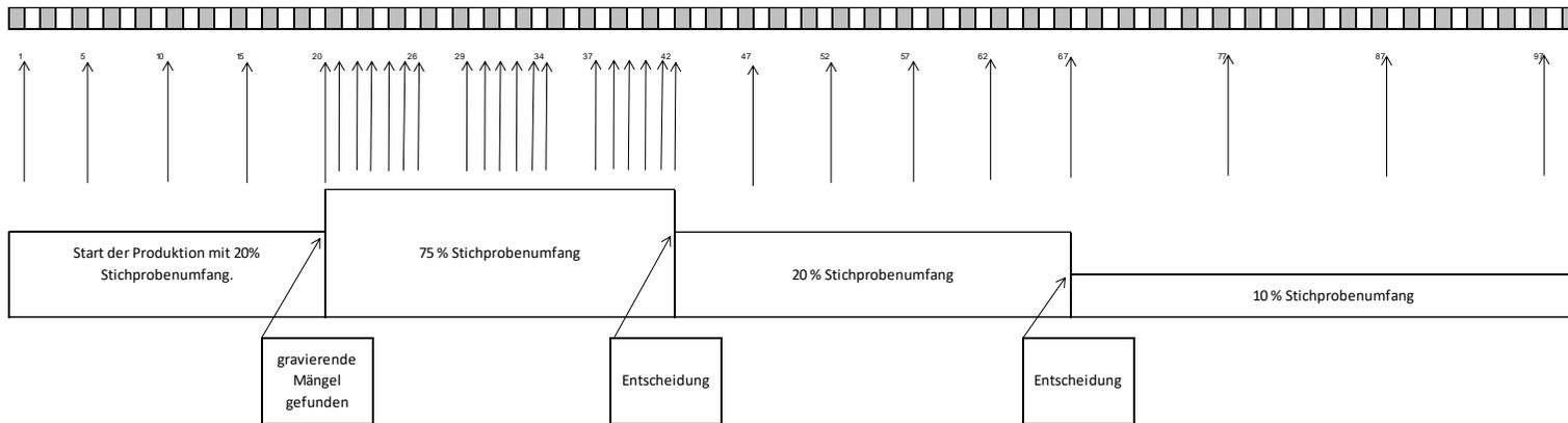
Abbildung 2-2: Darstellung des Umfangs im Fall von gravierenden Mängeln (beispielhafte Erweiterung auf 75%).
