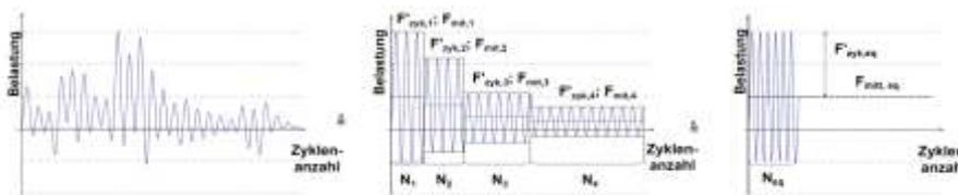
**Abbildung 3-I.2** Definition der äquivalenten Lastzyklenanzahl und Lastamplitude (vgl. EA-Pfähle)
